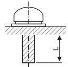
Certifique-se de que os parafusos tenham o comprimento especificado acima. Usar parafusos muito longos pode causar danos ao projetor. Usar parafusos muito curtos não proporcionará a resistência necessária para o suporte.
